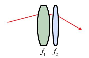
$$M_{tot} = \begin{bmatrix} 1 & 0 \\ -1/f_2 & 1 \end{bmatrix} \begin{bmatrix} 1 & 0 \\ -1/f_1 & 1 \end{bmatrix} = \begin{bmatrix} 1 & 0 \\ -1/f_1 - 1/f_2 & 1 \end{bmatrix}$$
